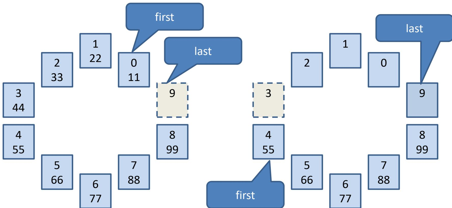
Изменение состояния буфера после извлечения четырех элементов.
